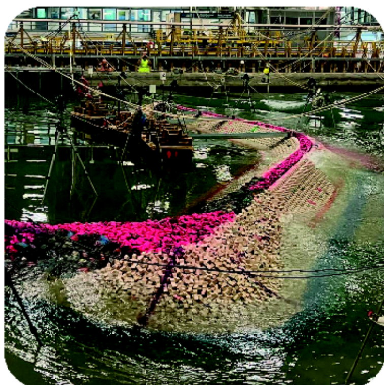
Modelagem física do quebra-mar em Out/23, Ottawa Canadá.
